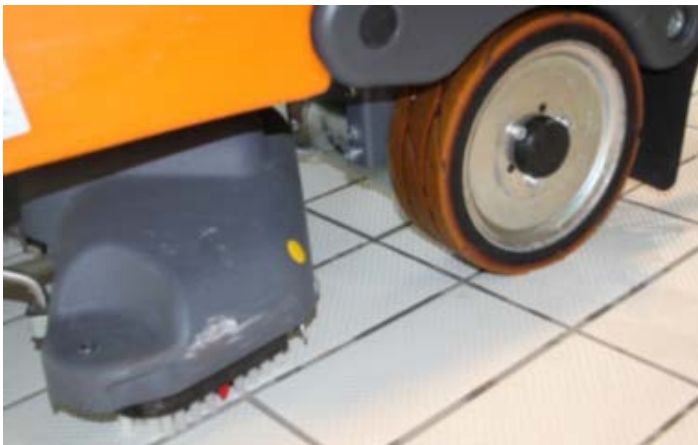
Figur 8 a og b: Rengjøringsmetoden er avgjørende for bestandigheten av fugene. Kraftig høgtrykkspyling, harde hjul og stive børster reduserer fugenes levetid.
