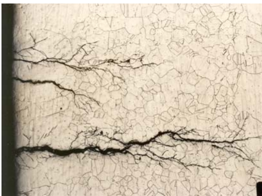
Figur 9 Klorid spenningskorrosjon i rustfritt stål (Ikke svømmehall)
