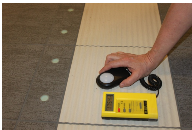
Figur 3: Et luxmeter gir mulighet å beregne luminanskontrast både på prøvefliser og på ferdig lagte flater.
