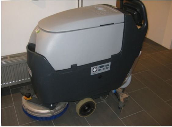
Figur 3a og b: Kombinasjonsmaskiner kan både vaske, skure og suge opp skittvann. Valg av rondell (pad) må tilpasses hardheten på golvet, smusstype og mengde. Bruk f.eks. ikke sort pad da det kan på sikt ripe eller matte ned overflaten. Hvite eller blå pad er ofte tilfredsstillende for de fleste tørre golv.
