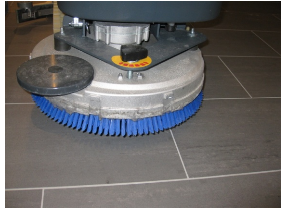
Figur 3a og b: Kombinasjonsmaskiner kan både vaske, skure og suge opp skittvann. Valg av rondell (pad) må tilpasses hardheten på golvet, smusstype og mengde. Bruk f.eks. ikke sort pad da det kan på sikt ripe eller matte ned overflaten. Hvite eller blå pad er ofte tilfredsstillende for de fleste tørre golv.
