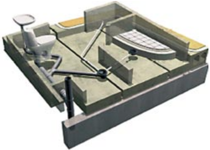
Figur 6: Et nedsenket våtromsdekke gir løsninger uten høydeforskjell mot tiliggende rom. Det kan benyttes over- eller underliggende membran til påstøpen. Benyttes underliggende membran, anbefales i tillegg påstrykningsmembran i selve dusjsonen for å holde gulvet tørrest mulig.
