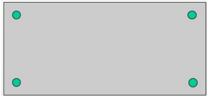
Figur 4: Plassering av innborrede festepunkter på 1000x 600 mm flis.
