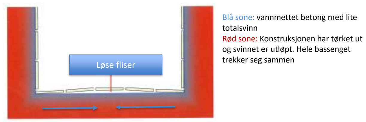
Figur 3: En betongkonstruksjon fortsetter å trekke seg sammen i flere år etter utstøping. (Illustrasjon: Sopro)
