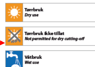
Figur7: Produktene merkes med noe ulike symboler, avhenging av leverandør. Merkingen kan se ut som her
